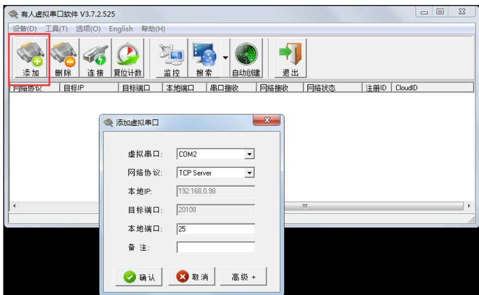
如图点击软件的**添加**按钮，在对话框的**虚拟串口**下拉菜单中选择想要虚拟成的串口号，在**网络协议**中选择 **TCP Server** 模式，注意**本地端口**号要和前面 **USR-M4** 配置工具中的**远程端口**号保持一致，这里我们需要填 **25**，然后点击**确认**。这时在界面中出现了 **COM2** 的信息，并且**网络状态**显示已连接，说明配置正确，如下图所示
