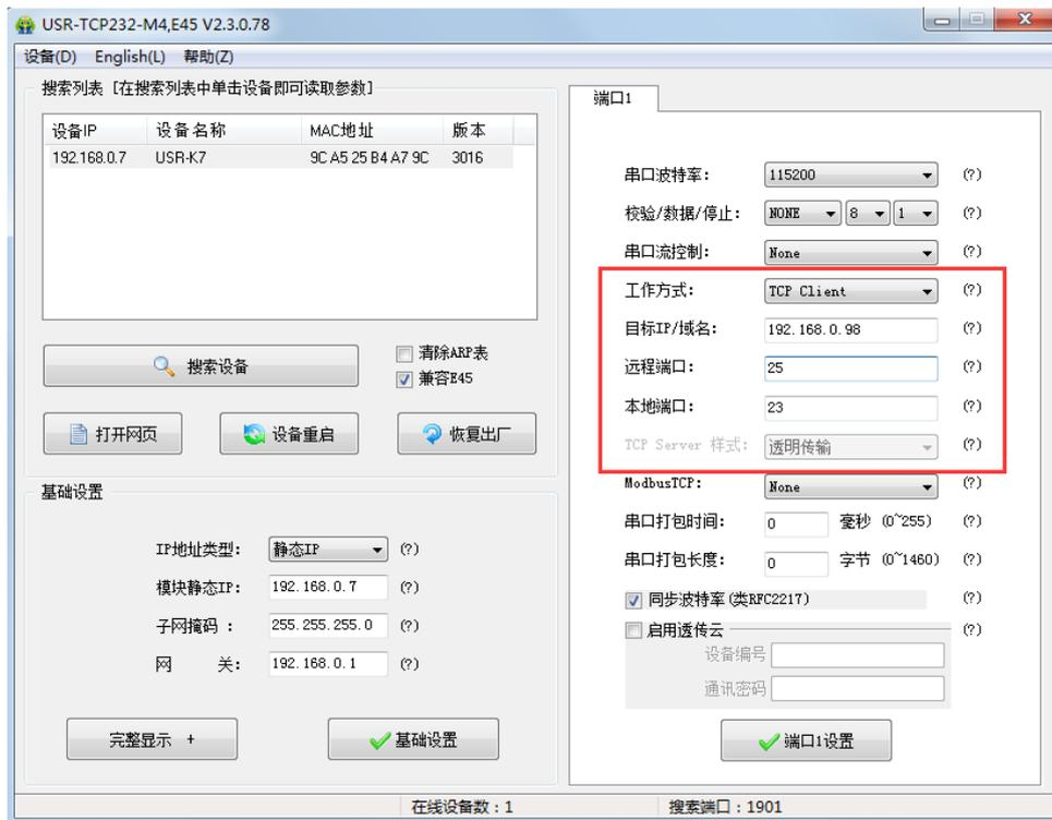
如图所示在**工作方式**下拉菜单选择 **TCP Client**，**目标 IP/域名**修改为要连接短信设备的服务器的 **IP**，**远程端口**默认是 **23**，可以自行修改，为方便区分后面的本地端口我将其修改成 **25**，然后点击**端口 1 设置**进行保存。
